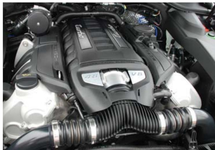
El motor V8 de 4,8 litros con 400CV equipado con caja Tiptronic de 8 velocidades.
